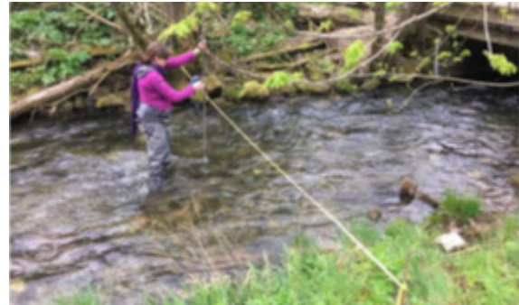
*Abbildung 1: Magnetisch-induktive Durchflussmessung
